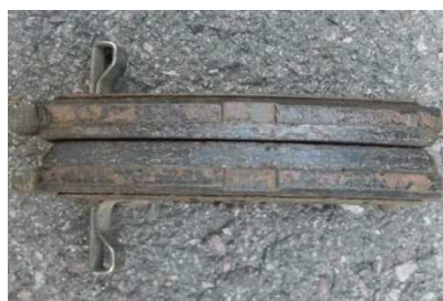
Рис. 6. Неравномерный износ фрикционных накладок тормозных колодок
