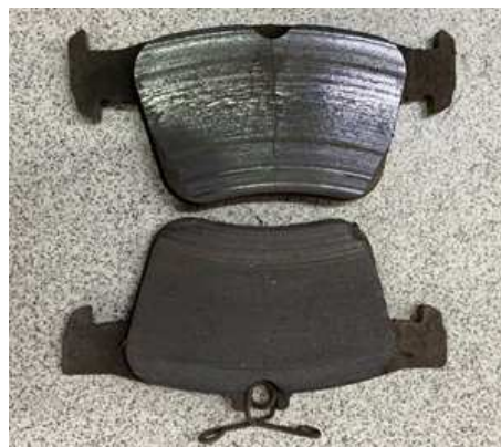
Рис. 9. Растрескивание фрикционных накладок
