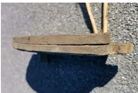
Рис. 1. Отклеивание фрикционной накладки от несущей пластины
