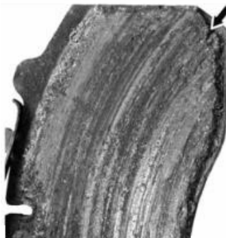
Рис. 4. Повреждение тормозной колодки в результате выкрашивания фрикционного материала на рабочей поверхности и кромок фрикционной накладки
