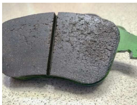
Рис. 2. Повреждение тормозной колодки при тепловой перегрузке
