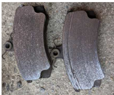
Рис. 3. Повреждение тормозной колодки в результате задигов на рабочей поверхности
