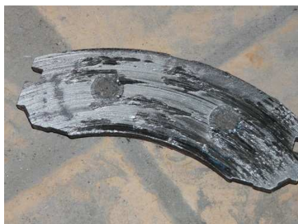
Рис. 5. Чрезмерный износ тормозных колодок
