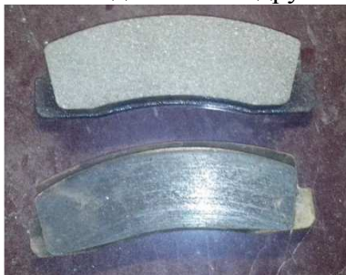
Рис. 7. Остекление фрикционной накладки
