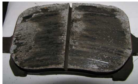
Рис. 8. Загрязнение фрикционной накладки
