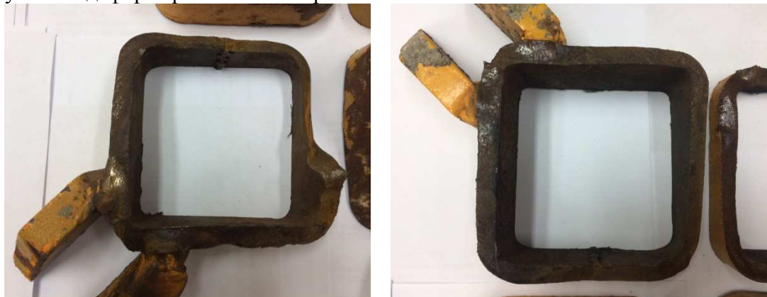
Рис. 3. Развитие усталостной трещины
