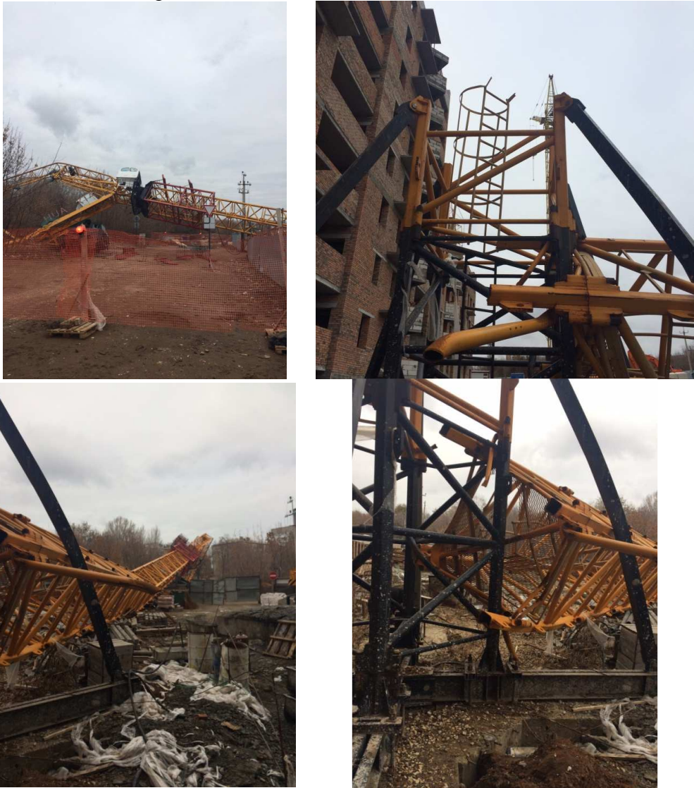
Рис. 1. Место после аварии башенного крана QTZ160
