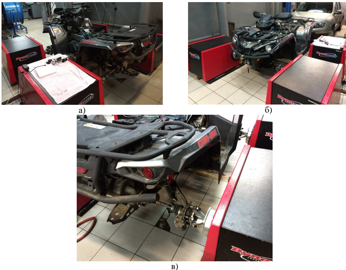
Рис. 1. Квадроцикл установленный на динамометрическом стенде DynaPack: а) вид сзади; б) вид спереди; в) вид на подключение ступицы колеса к нагрузателю
