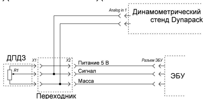
Рис. 4. Схема переходника для снятия сигнала с ДПДЗ
