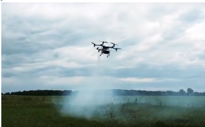
Рис. 1. Гексакоптер OSA HEXA F-1 с генератором горячего тумана
