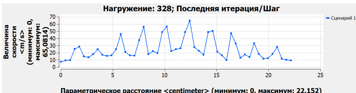
Рис. 11. График пульсаций струй за разрезным козырьком
