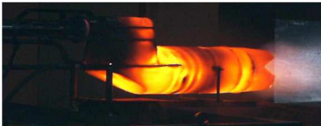
Рис. 17. Влияние аэродинамических факторов и конического стабилизатора на сдвиг зоны горения в проточной части двигателя
