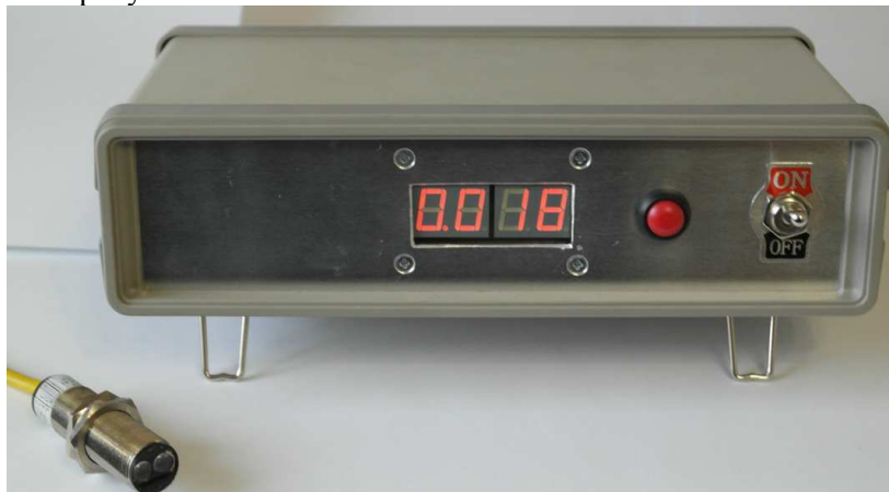
Рис. 4. Внешний вид прибора с бесконтактным оптическим датчиком
