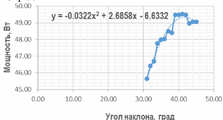
Рис. 2. Зависимость мощности от угла наклона солнечной панели
