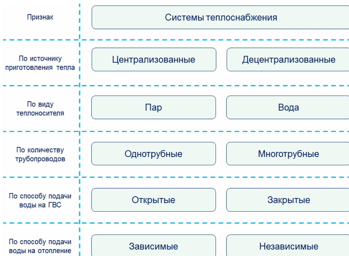
Рис. 1. Классификация трубопроводных систем теплоснабжения
