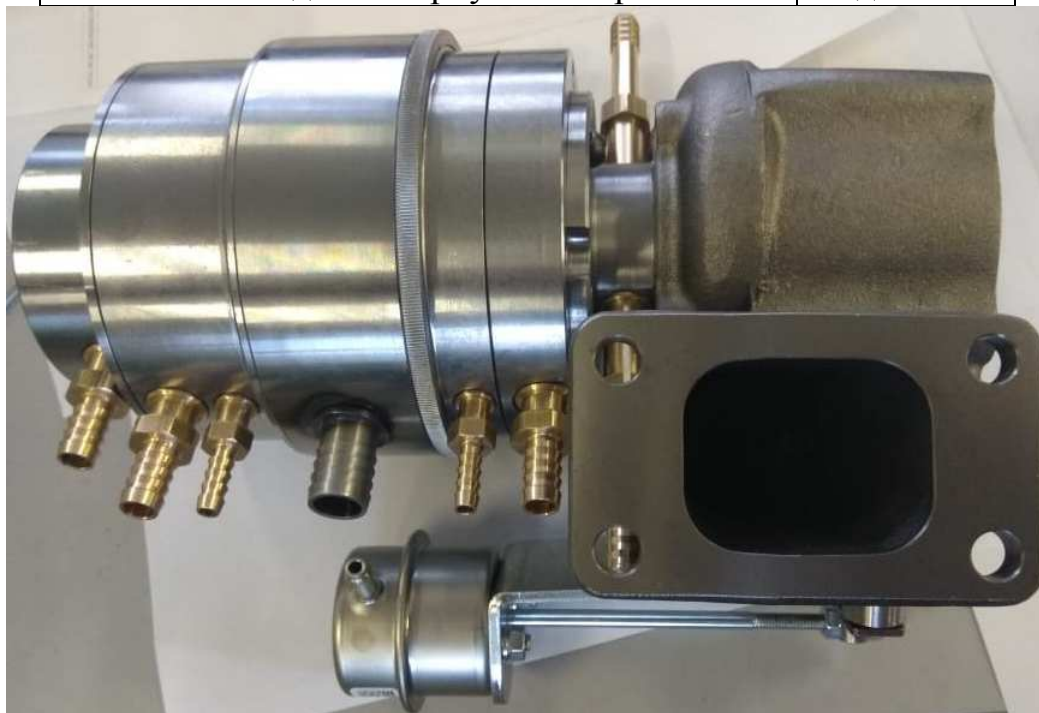
Рис. 1. Общий вид турбогенератора
