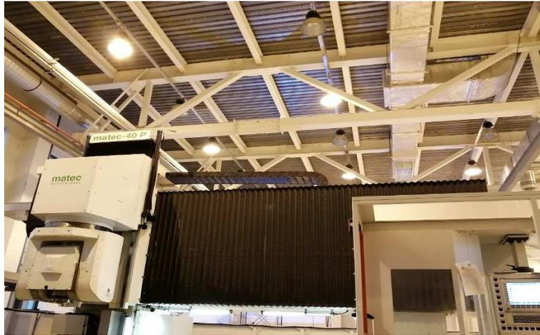
Рис. 1. Установка импульсной сварки трением с перемешиванием МАТЕС-40Р
