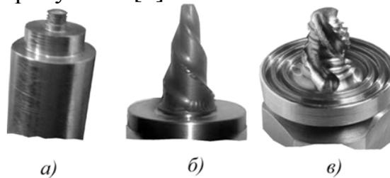
Рис. 2. Рабочие части инструментов: а – традиционная конструкция инструмента; б – инструмент для получения глубоких швов; в – инструмент со специальной формой торца
