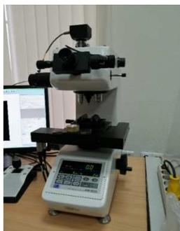
Рис. 9. Автоматический микротвердомер Future-Tech FM-300
