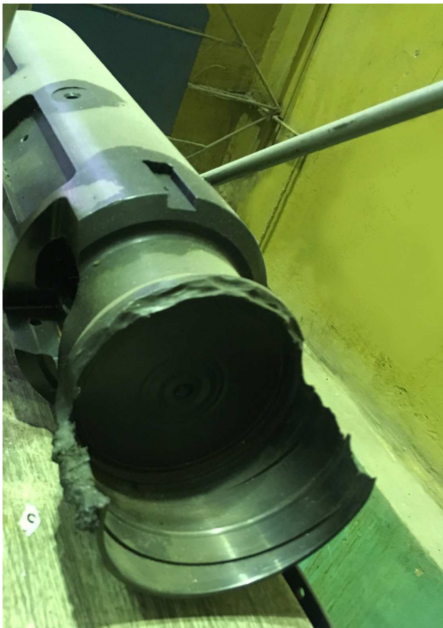
Рис. 1. Разрушенная расточная головка
