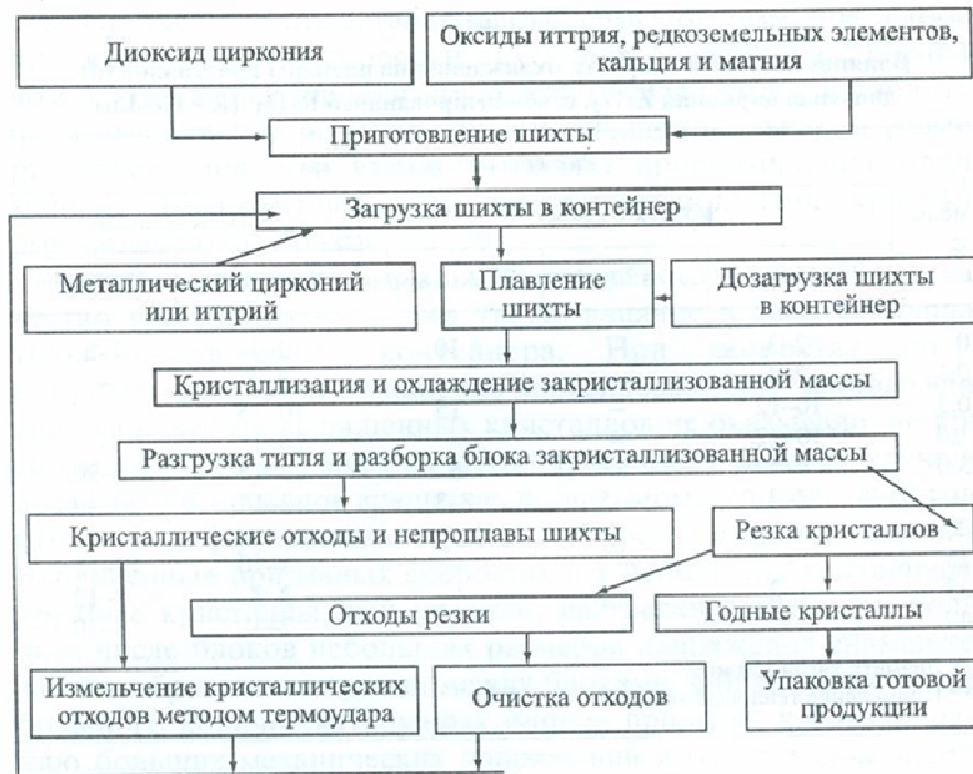
Рис. 1. Схема технологического процесса производства кристаллов ЧСЦ
