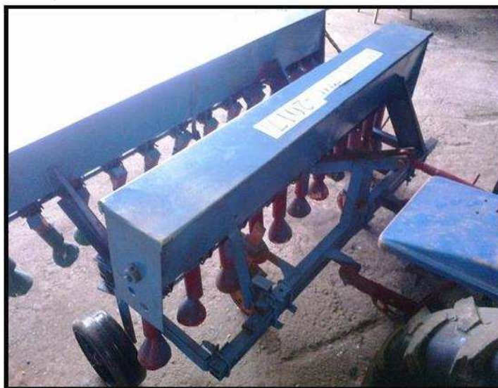
Рис. 2. Опытный образец сеялки травосмесей в агрегате с минитрактором Феншоу-180
