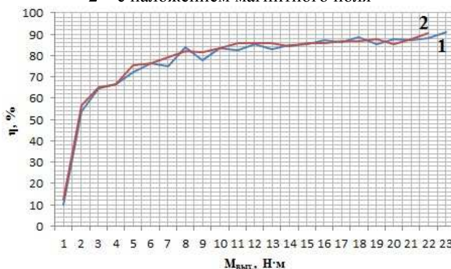
Рис. 5. График КПД при 800 об./мин.: 1 – без наложения магнитного поля; 2 – с наложением магнитного поля
