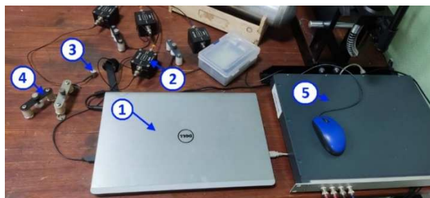
Рис. 2. фотография подготовленного оборудования для исследования: 1 – ноутбук для вывода результатов; 2 – предусилитель; 3 – тензометрический датчик; 4 – кронштейн крепления; 5 – акустико-эмиссионная система
