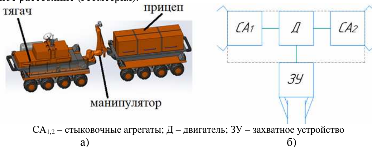
Рис. 1. Автономная РТС в сцепке с прицепом: а) вариант сцепки РТС с прицепом с помощью ЗСУ; б) функциональная схема ЗСУ
