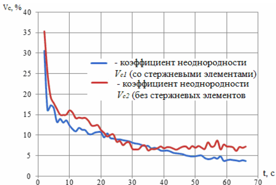
Рис. 5. График изменения коэффициента неоднородности в зависимости от времени симуляции процесса смешивания
