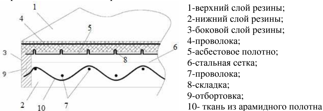
Рис. 1. Частично увеличенный вид продольного сечения прочной резиновой конвейерной ленты
