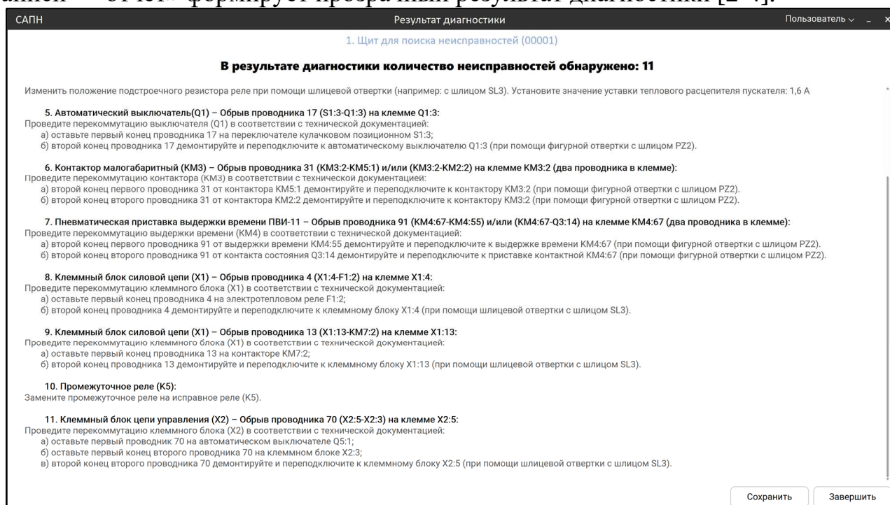
Рис. 3. Экран «Результаты диагностики» (перечень выявленных неисправностей с локализацией и рекомендуемыми действиями)
