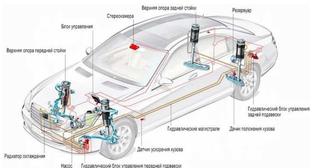
Рис. 3. Конструкция адаптивной САРП автомобиля
