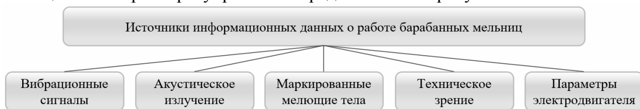
Рис. 3. Источники информативных данных о работе барабанных мельниц
