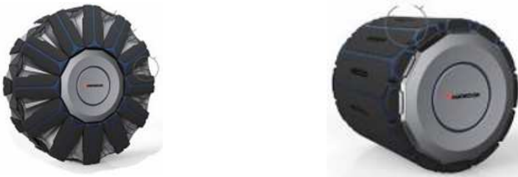
Рис. 3. Адаптивный колёсный движитель компании Hankook
