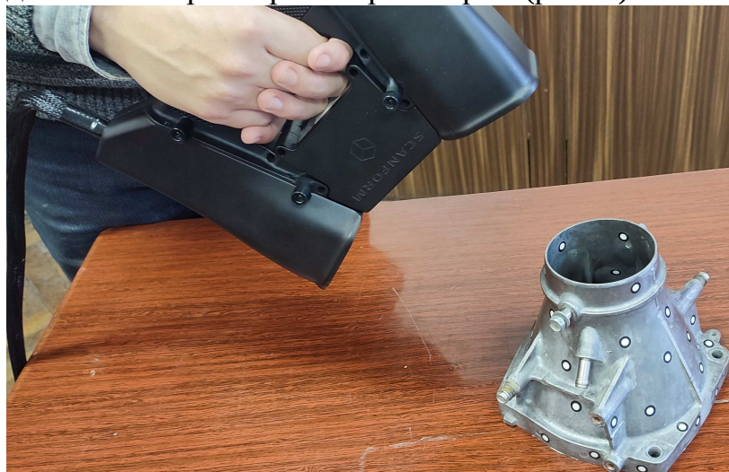
Рис. 2. Сканирование спрямляющего устройства водомета
