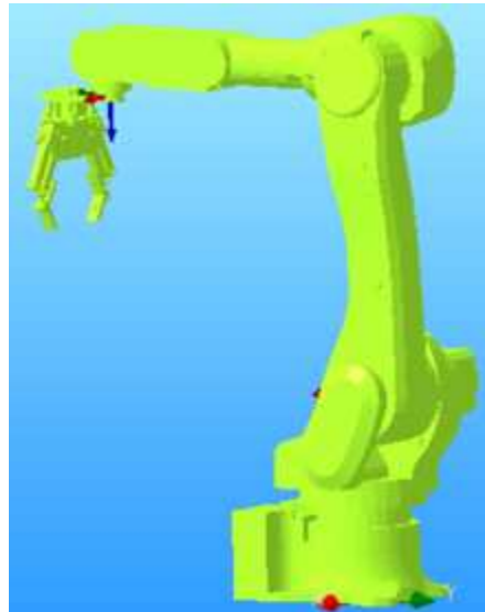
Рис. 2. Модель робота Kawasaki RS010N с разработанным захватным устройством в программной среде K-ROSET
