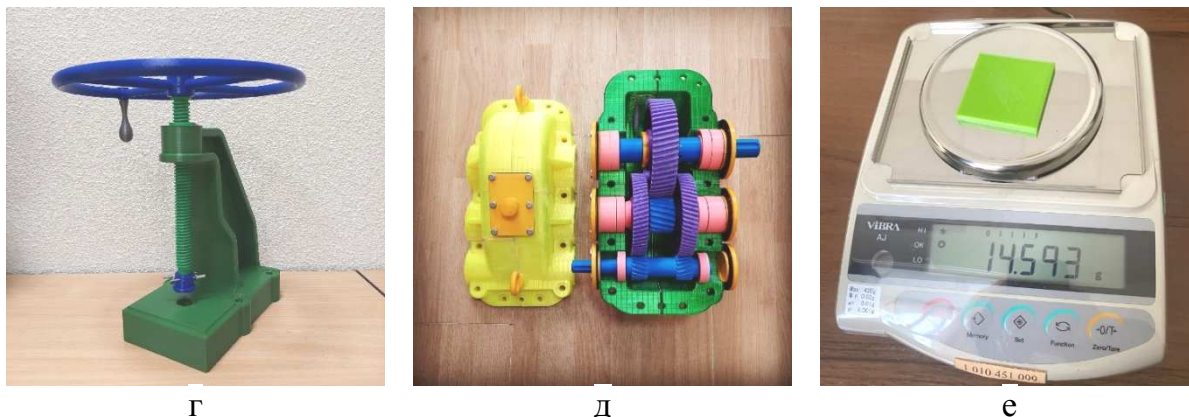
Рис. 7. Изделия 3D печати: г) струбцина, д) редуктор цилиндрический, е) образцы для испытаний
