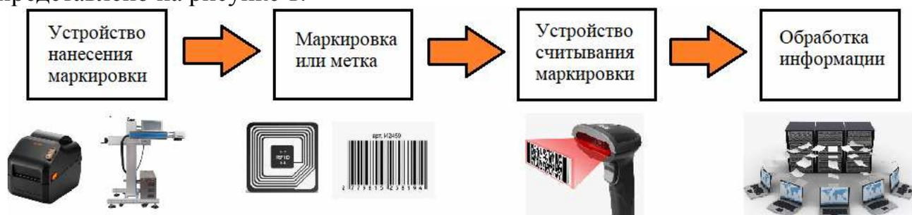
Рис. 1. Общая структура автоматизированной системы идентификации
