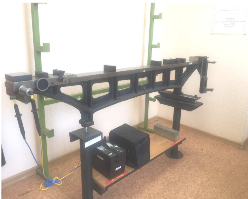
Рис. 1. Стенд типа 31000 для контроля путевых шаблонов
