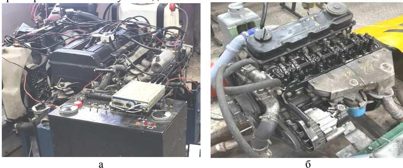
Рис. 3. Двигатели внутреннего сгорания применяемы при проведении экспериментальных исследований: а) B20 Хонда (бензиновый); б) TD27 Ниссан (дизельный)
