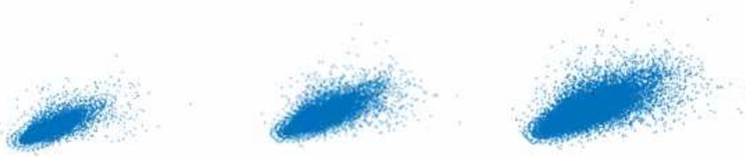
Рис. 4. Временные фазовые портреты сигнала ВАЭ при трении по оси  $Y$
