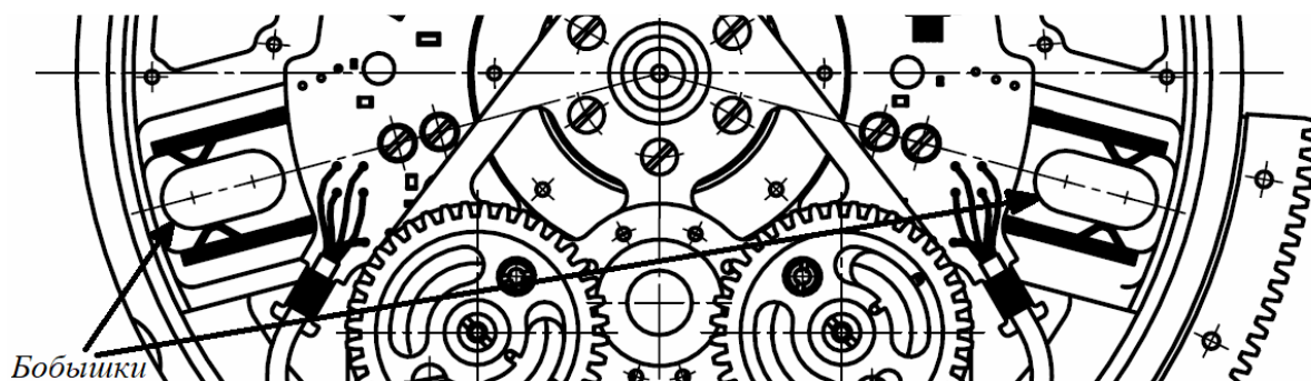
Рис. 2. Механизм воздействия на плоские пружины
