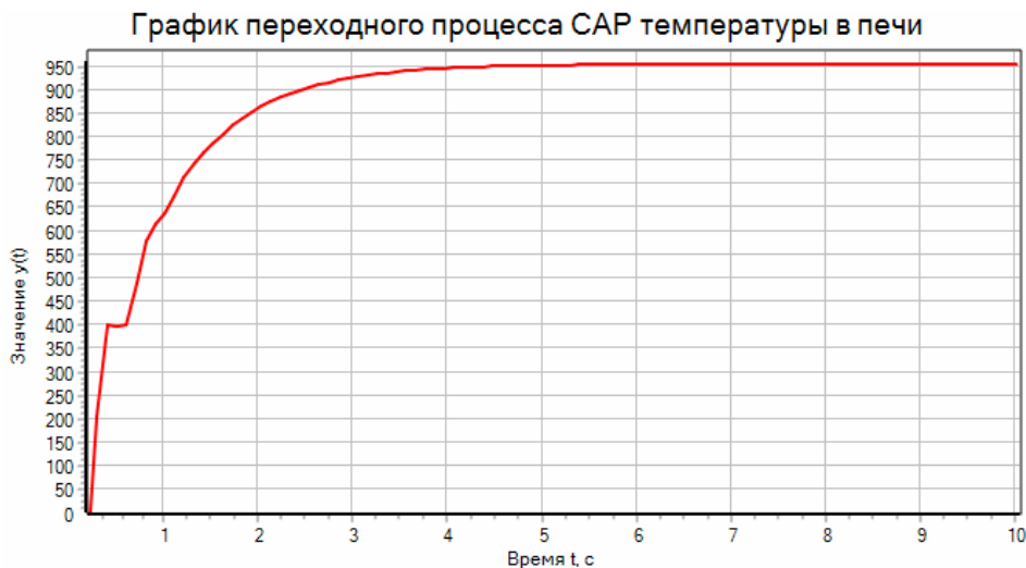
Рис. 5. График переходного процесса САР по задающему воздействию
