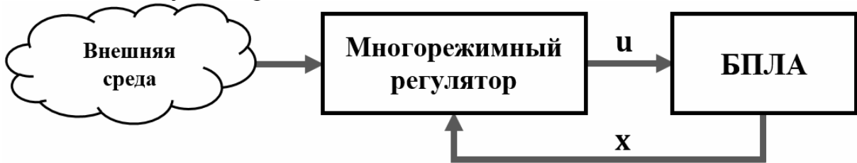
Рис. 1. Блок-схема управления БПЛА: u , x – управляющий вход и состояние аппарата
