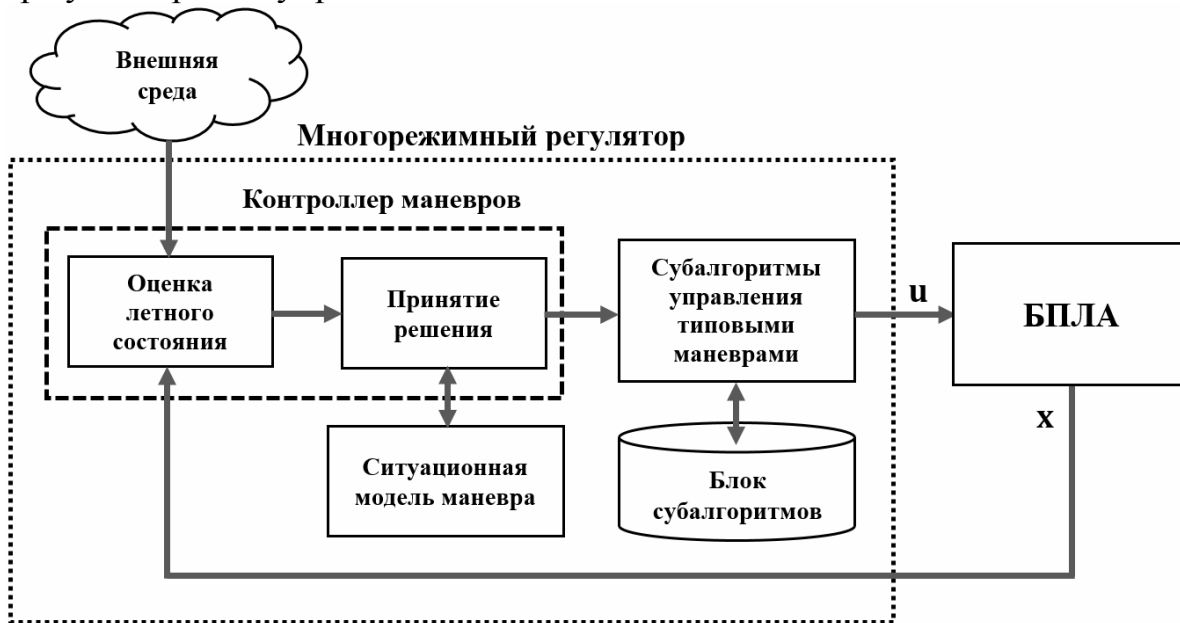
Рис. 2. Структура многорежимного регулятора
