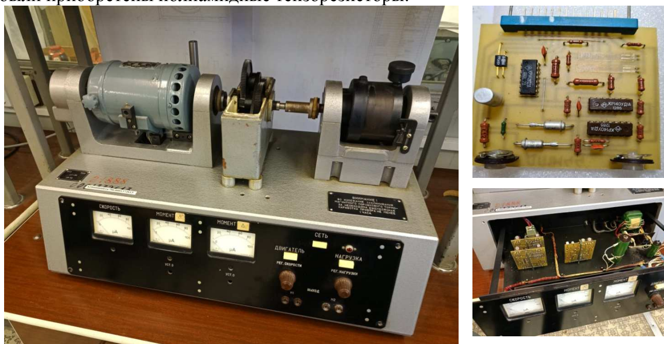
Рис. 1. Общий вид используемой установки и фотография платы первичного тензопреобразователя
