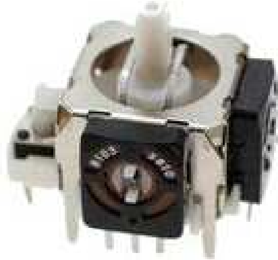
Рис. 2. Манипулятор с аналоговым принципом преобразования
