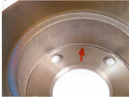
Рис. 5. Образование следа от неправильной посадки тормозного диска на ступицу
