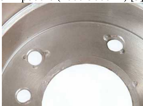
Рис. 2. Наличие подтеков защитных лакокрасочных покрытий на сопрягаемой поверхности тормозного диска
