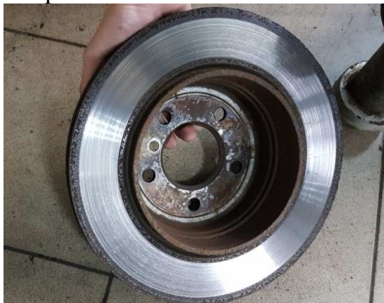
Рис. 3. Коррозия на сопрягаемой поверхности тормозного диска
