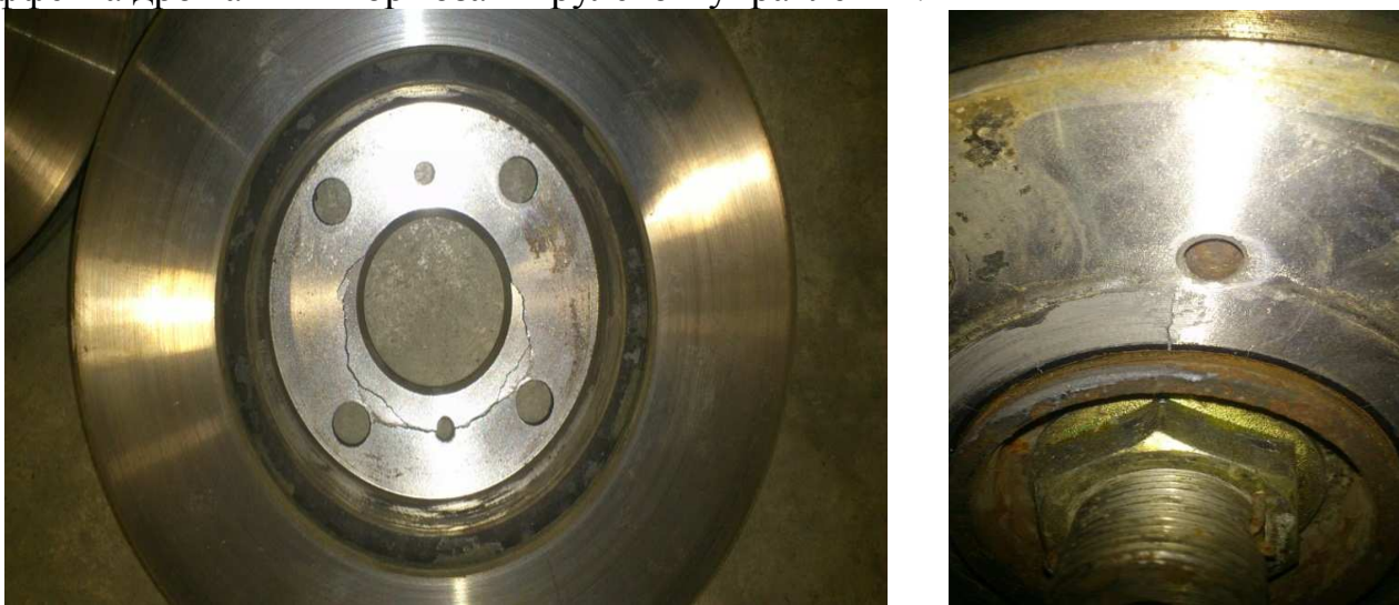
Рис. 4. Образование трещин в области отверстий на сопрягаемой поверхности
