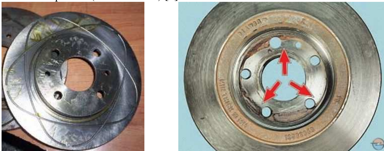
Рис. 1. Наличие оставшегося консерванта на сопрягаемой поверхности тормозного диска
