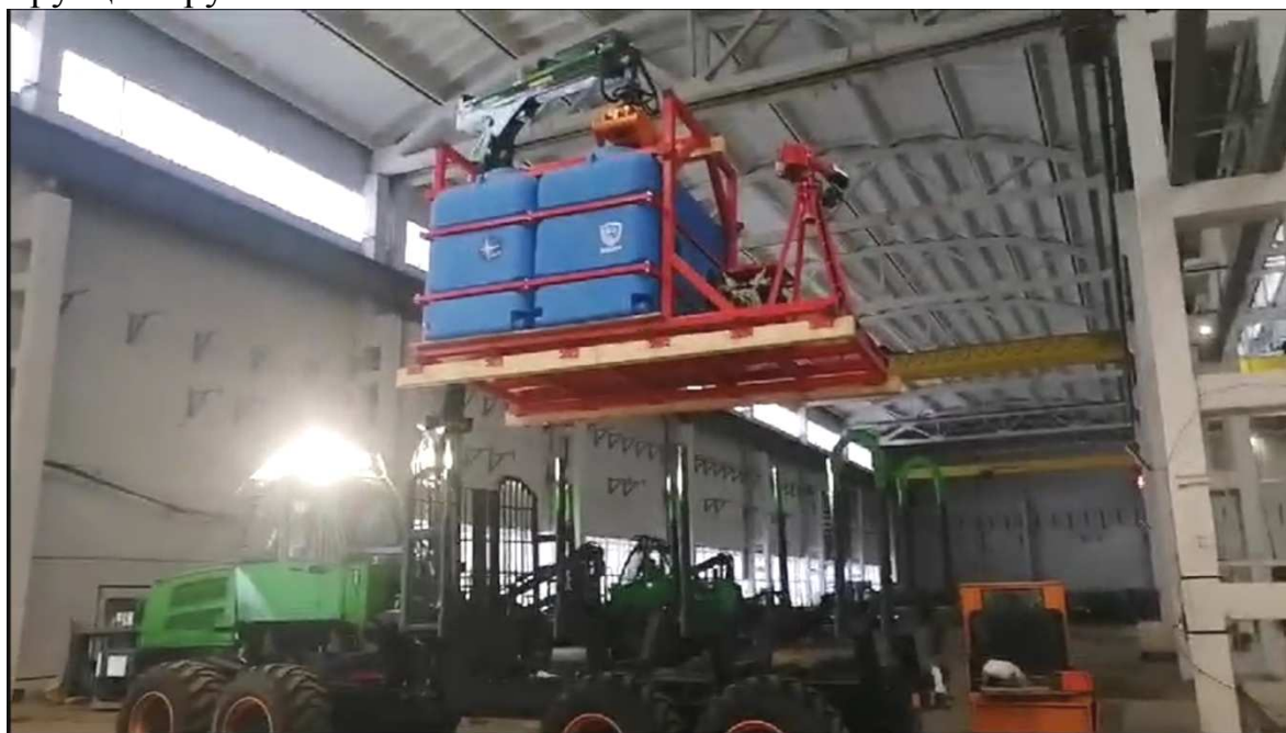
Рис. 1. Погрузка модульной установки для пожаротушения в грузовой отсек манипулятором форвардера «Амкодор-2662» (фрагмент испытаний)
