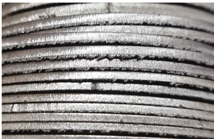
Рис. 1. Кромки материала после лазерной резки
