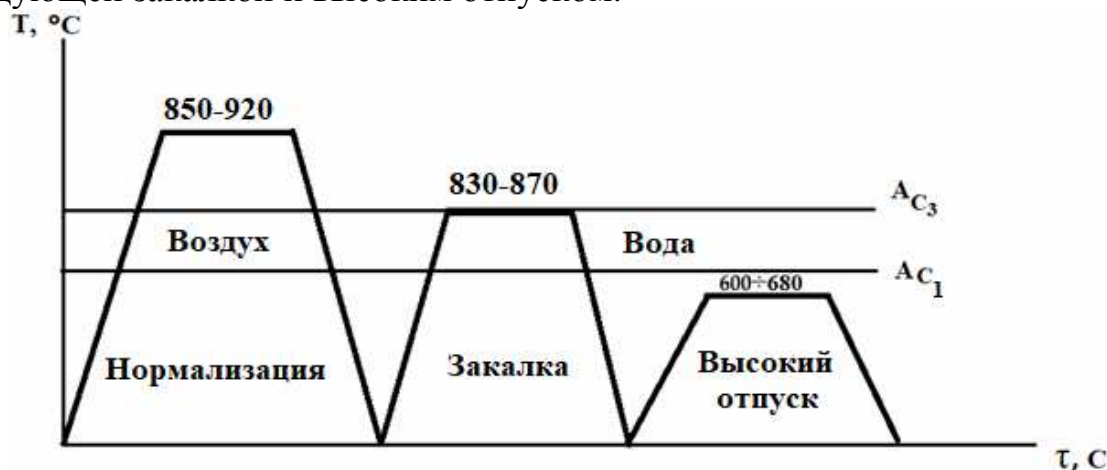
Рис. 1. График нормализации труб из различных сталей с последующей закалкой и высоким отпуском
