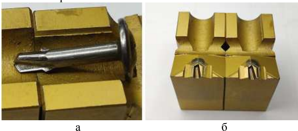
Рис. 1. Заготовка винта для металла после операции формообразования сверла (а), плашки, формообразующие сверло (б)
