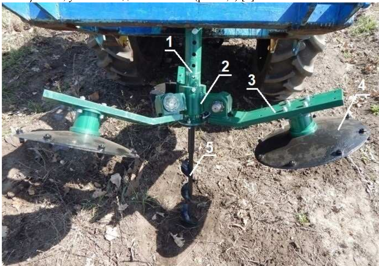
Рис. 1. Экспериментальный образец универсального почвообрабатывающего орудия: 1-опорный вал, 2- обойма, 3-поводок, 4-дисковые корпуса, 5-винтовой бур
