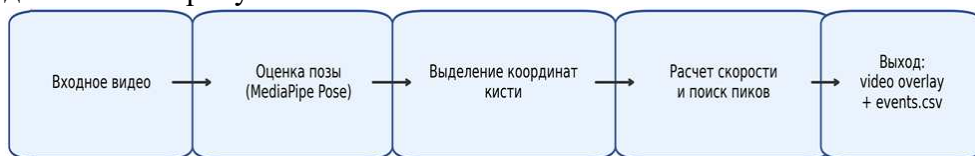
Рис. 1. Общая схема алгоритма детектирования ударов
