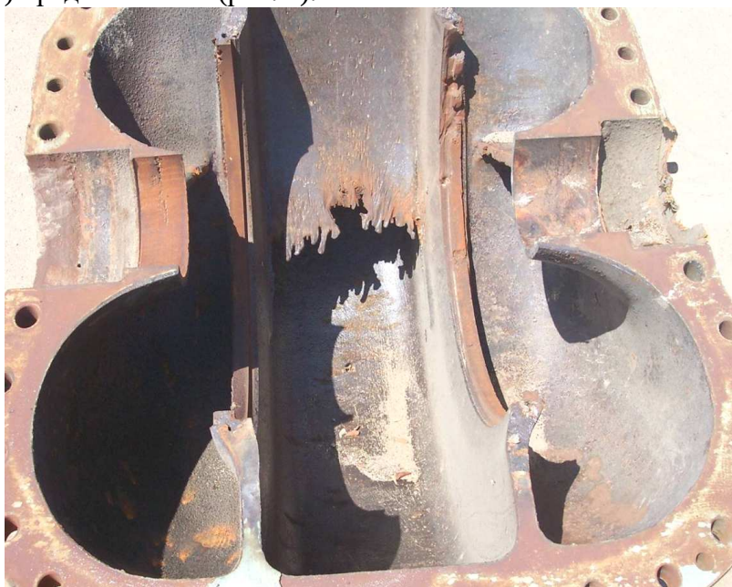
Рис. 2. Изношенный корпус насоса
