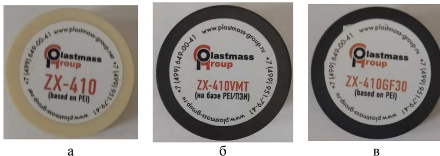
Рис. 1. Образцы полиэфиримида и композитов на его основе: а – ZX-410, б – ZX-410VMT, в – ZX-410 GF30
