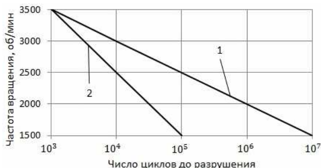
Рис. 3. Ресурс РКО при значениях размера A : 1 – 165 мм; 2 – 170 мм
