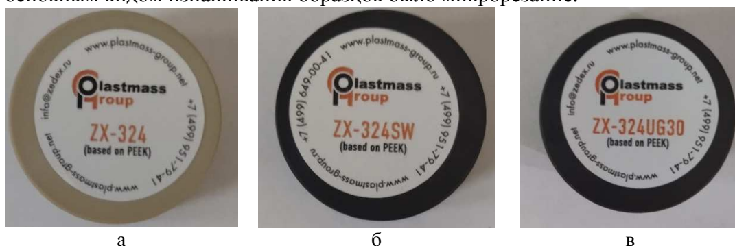
Рис. 1. Образцы для испытаний закрепленным зерном: а ПЭЭК, б – ПЭЭК/СВ, в – ПЭЭК/УВ
