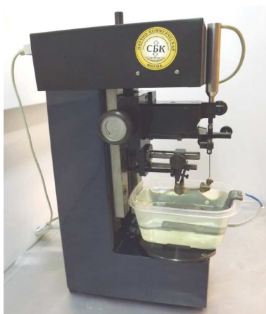
Рис. 1. Автоматизированная установка АСБ-1 для определения остаточных напряжений
