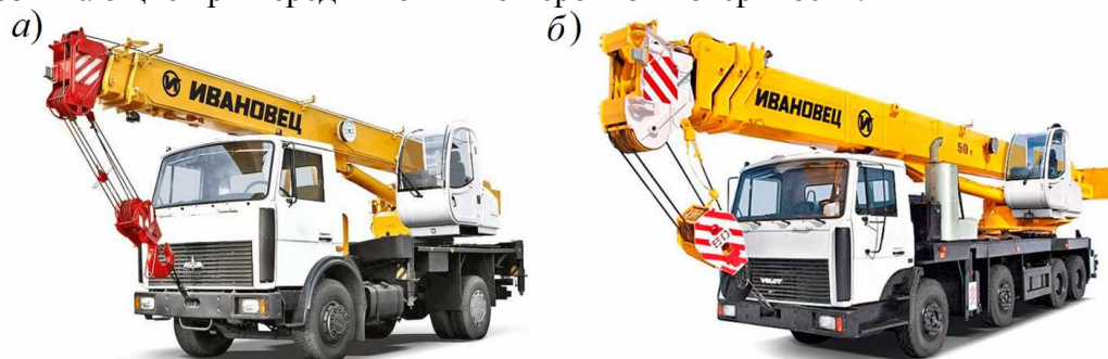
Рис. 1. Стреловые самоходные краны на колесном ходу: а – автомобильный кран КС-35715; б – кран на специальном шасси автомобильного типа КС-6476
