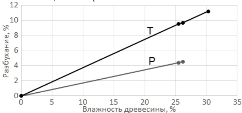
Рис. 2. Зависимость разбухания в тангенциальном (Т) и радиальном (Р) направлениях древесины сосны от влажности.
