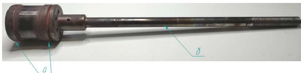
Рис. 1. Фотография типичного плунжера: а – головка плунжера, б – шток/направляющая плунжера
