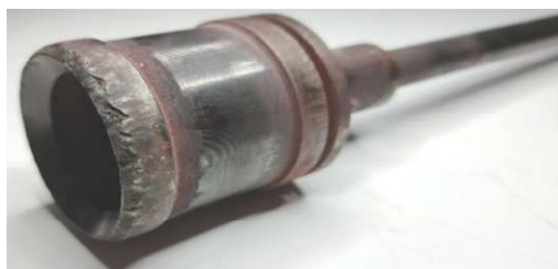
Рис. 2. Поверхностный износ рабочей части головы плунжера
