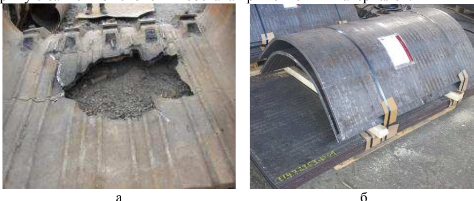
а б Рис. 1. Катастрофический износ ковша экскаватора (а); наплавленные биметаллические плиты для ремонта и восстановления (б). Фотографии предоставлены ООО «РСТП»
