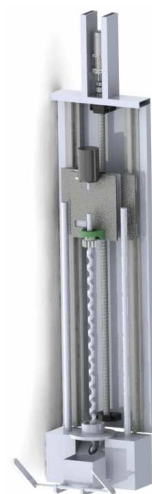
Рис. 2. Автоматический пробоотборник сверлильного типа
