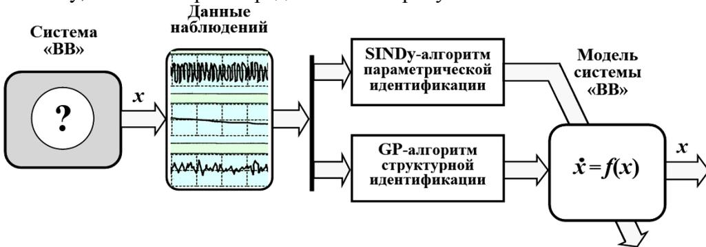
Рис. 3. Схема гибридного метода GP-SINDy идентификации динамической системы «BB»
