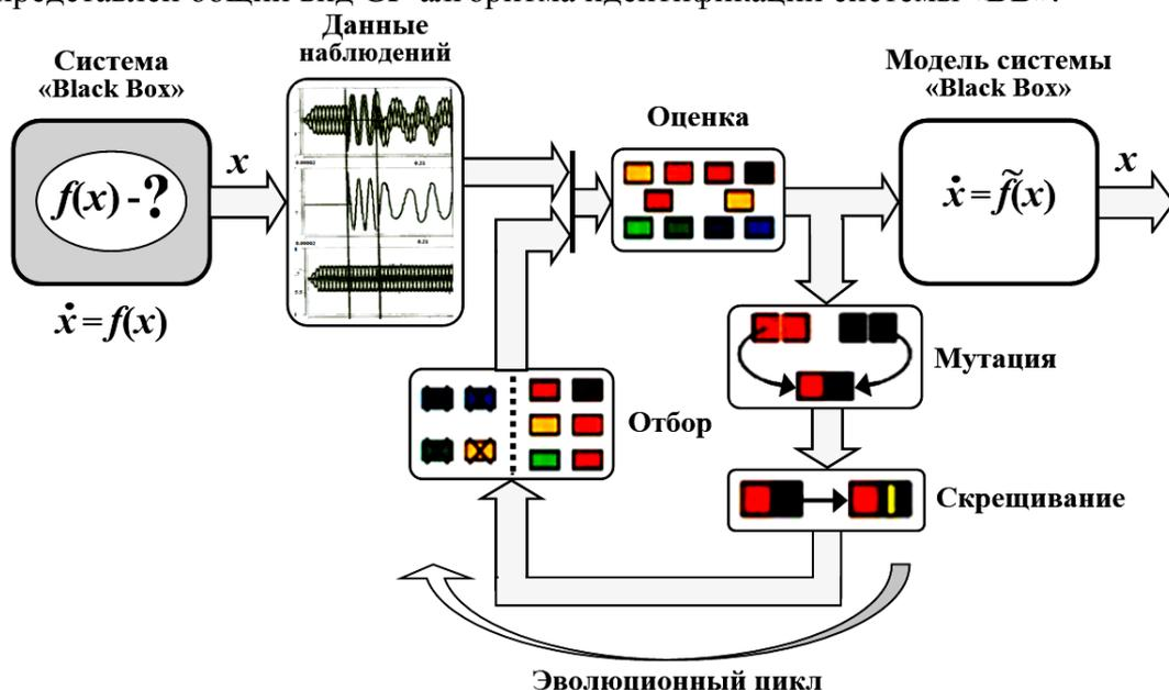
Рис. 1. Схема GP-алгоритма идентификации системы «ВВ»
