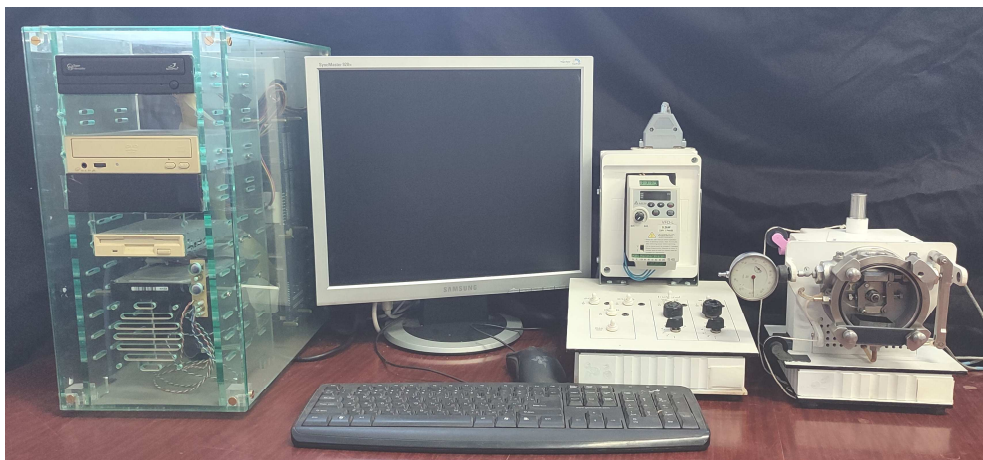
Рис. 1. Триботехнический комплекс для ускоренных испытания конструкционных материалов и покрытий на трение и износ
