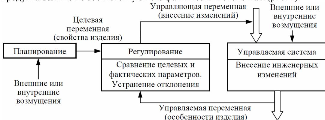
Рис. 1. Контур управления инженерными изменениями в изделии
